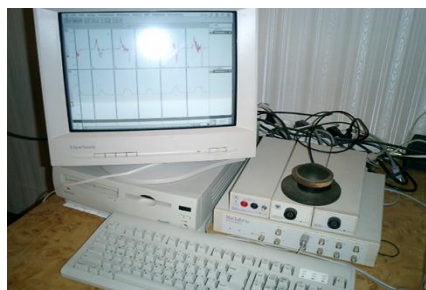
Аппаратно-программный комплекс MacLab-4e (ADInstruments, Австралия) с подключенным к нему датчиком динамического усилия
