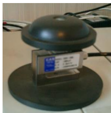
ДАТЧИК МЕХАНИЧЕСКОГО УСИЛИЯ НА ОСНОВЕ СИЛОВОЙ ЯЧЕЙКИ SBA-100L (CAS CORPORATION, KOREA)
